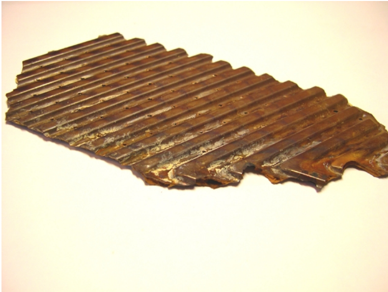
Рис. 3. Образец отложений, извлеченный из пластинчатого теплообменника (г. Сергач)
