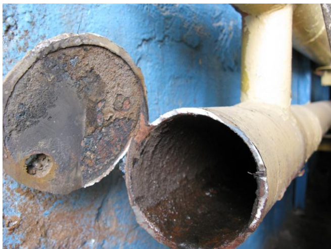
Регистры из гладких труб в проточном и тупиковом участках теплосети. Май 2010 г.
